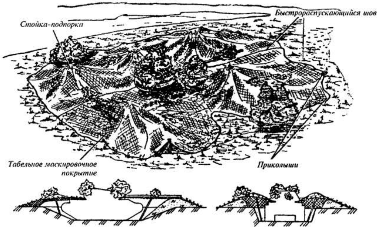
Рис. 25. Маскировка боевой техники в окопе под фон местности (вариант)
